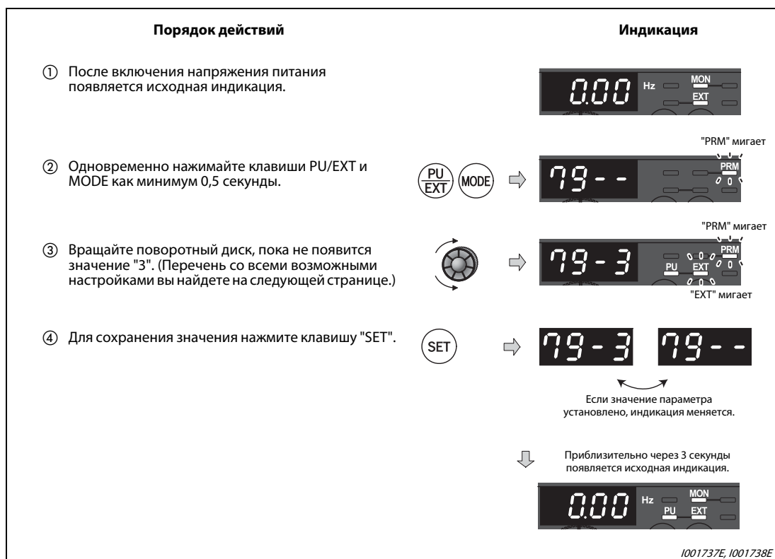
Рис. 4-8: Одновременно нажав клавиши PU/EXT и MODE, параметр 79 можно изменить сразу.
