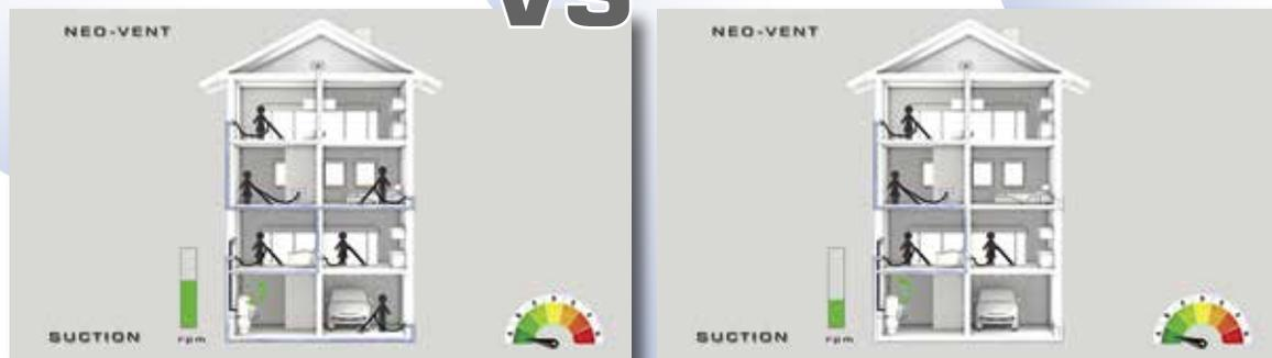
В **NEO-VENT** скорость уменьшается в зависимости от используемого воздуха, а потребляемая мощность уменьшается в геометрической прогрессии в соответствии с уменьшением скорости
