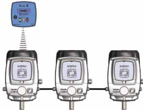
есть возможность добиться синхронной работы 2-8 NEO-Wi-Fi, управляемых одним пультом\панелью, соединив их в режиме работы главный-подчиненный. Подчиненные преобразователи могут функционировать и без пульта, как только они сконфигурированы в соединении RS485
